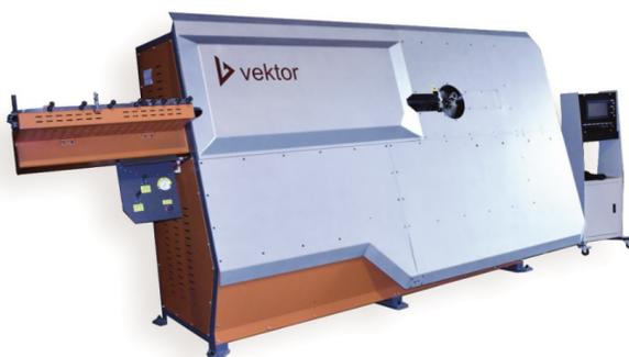
Гибочный станок для стальной арматуры с ЧПУ может гнуть и резать стальную горячекатаную арматуру  $\cdot 6 - 12$  мм, круглую арматуру гладкого профиля и холоднокатаную стальную арматуру. Станок обладает высокой точностью, высокой скоростью, стабильными механическими свойствами
