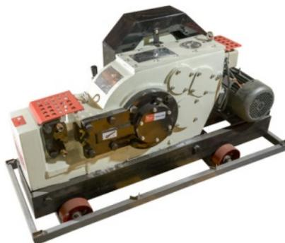
Резчики арматуры применяются для качественной и высокоточной обработки стальных прутьев, арматуры с винтовой нарезкой или без нее.
