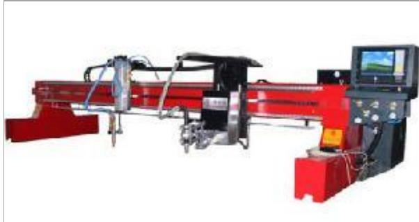
Одной из основных заготовительных операций в современном производстве металлических конструкций, машиностроении и других отраслях является резка листового металла труб. В настоящее время разработаны и автоматизированы различные процессы резки - газовая (газокислородная резка), плазменная, лазерная, гидроабразивная. Наиболее востребованными способами резки являются газовая и плазменная резка.
